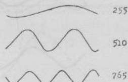
Fig. 65. — Onde semplici (isolate per mezzo dell'analisi algebrica) componenti il ciclo tipico oscillografico della vocale « u » del soggetto 1 (freq. fond. = 255 cicli/sec.).
