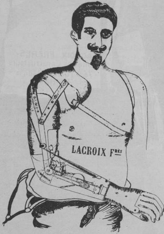
FIG. 8. — Planche d'études pour la cinéprothèse de l'amputé de l'Obs. III. Cette cinéprothèse permet tous les mouvements physiologiques.
