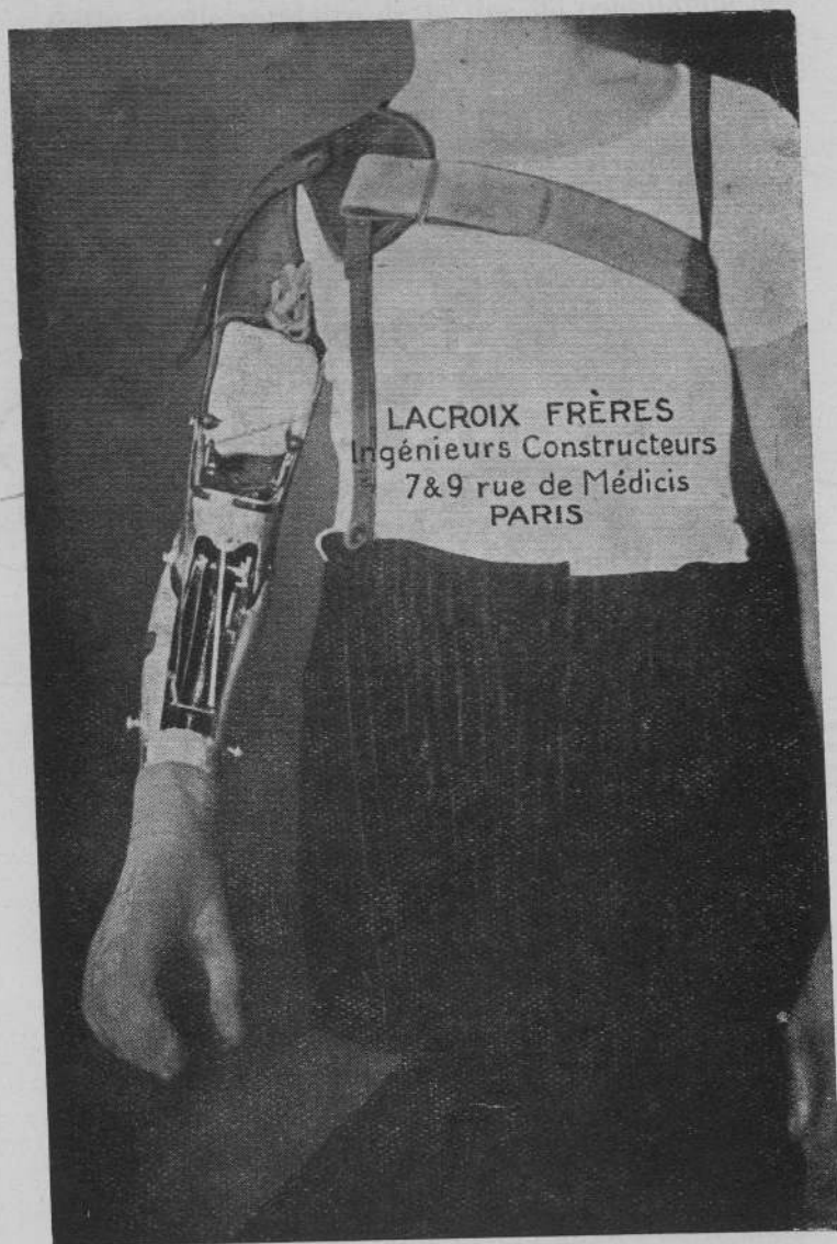
FIG. 7 (Amputé de l'Obs. III). — Cinéprothèse pour unimoteur biceps actionnant le mécanisme de préhension (Le poids soulevé par les doigts était de l'ordre de 12 à 15 kilos).
